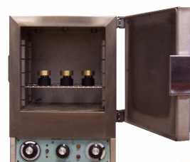
Zeitverfestigung von 3 Proben in einem Klimaschrank
