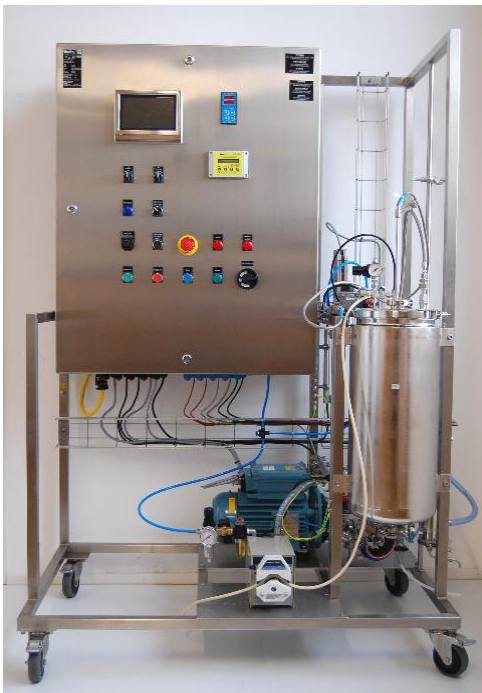
Abb. 8.5 Pilotanlage in ATEX Ausführung für organische Lösungsmittel
