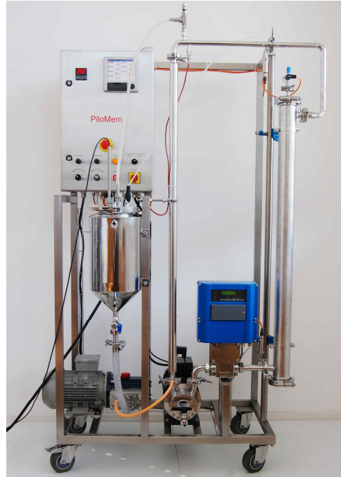
Abb. 8.4 Anlage mit 2 separaten Pumpen erlaubt höhere Überströmungen
