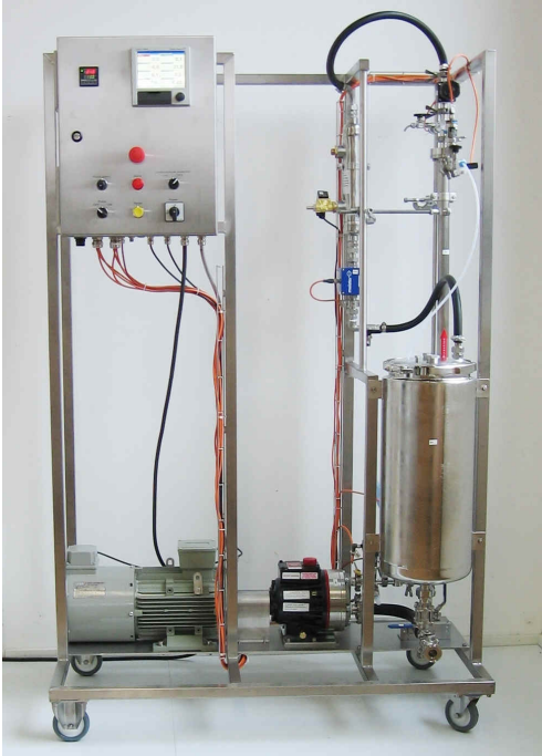
Abb. 8.3 Pilotanlage mit einer Pumpe für Druckerzeugung und Überströmung
